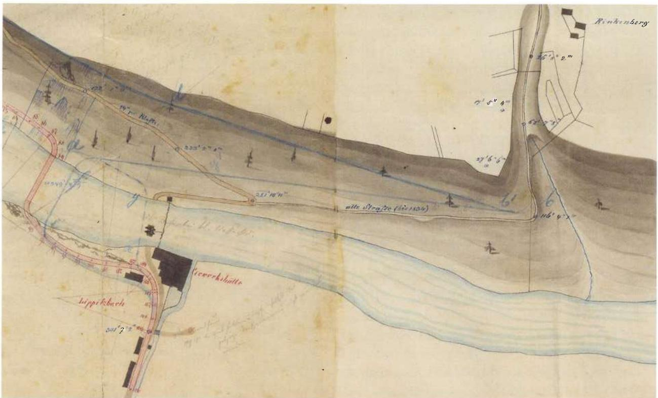
Abb. 8: Plan für den Bau der Lippitzbachbrücke und die Verlegung der Straße zur Überwindung des Draurains (1862). Der Plan zeigt auch die Fähre, die Straße, wie sie bis 1896 Bestand hatte und die alte Straße nach Rinken- berg, die 1834 verlegt wurde (KLA).
