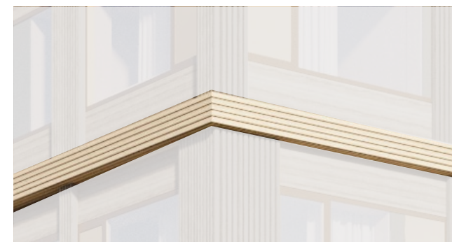
Hinterlüftete Fassade | Schalung horizontal 60/20 mit Fuge Konterlattung
