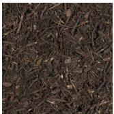
Naturpfad Unterhalt Holzhäckselmulch 15-24mm Schichtdicke 8cm
